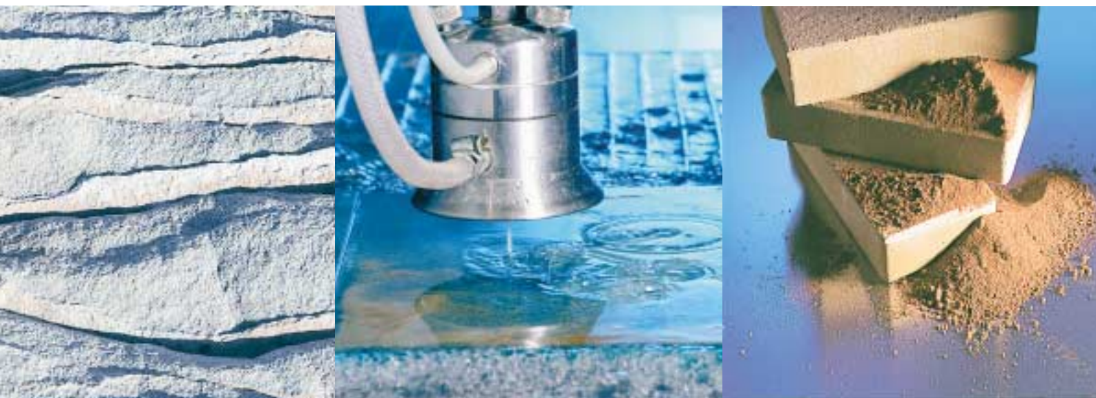
Waterjet-metoden används för att skära all slags material, en vattenstråle med granat används som skärmedel. I byggnadskonstruktioner används mineralerna mangan och hematit för att färga stenarna.
