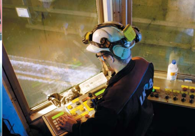
Från sin manöverpanel styr Daniel Sedig lastningen av pellets till järnvägsvagnar.
